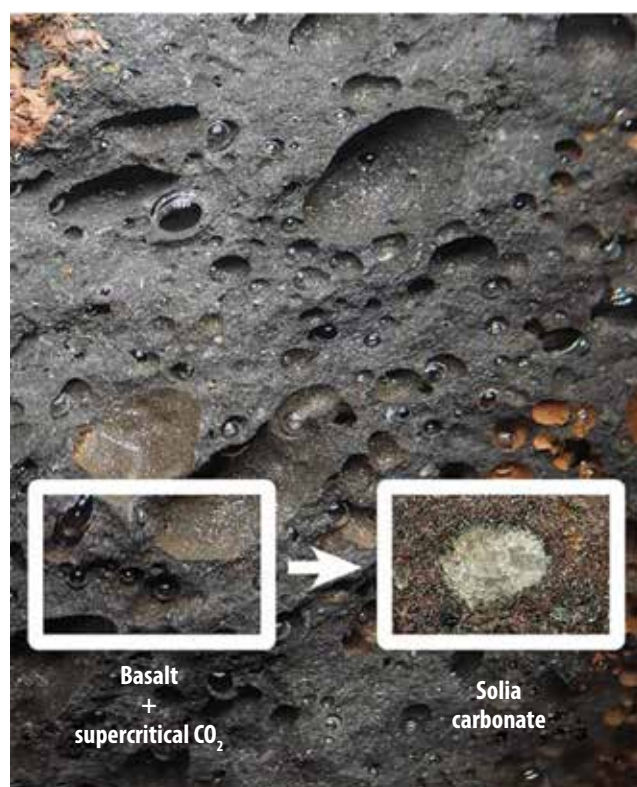
Hình 7. Kết hạch carbonate hình thành trong quá trình lưu trữ CO 2 trong tầng basalt dạng bọt. Nguồn: Pacific Institute for Climate Solution (PICS).
